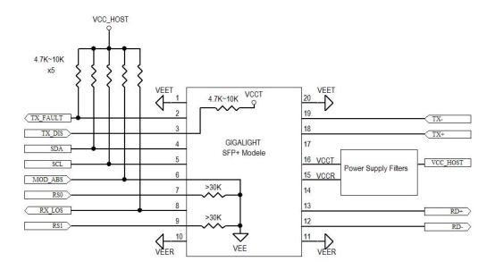
Figure 4. Host-Module Interface
