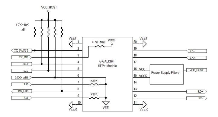
Figure 4. Host-Module Interface
